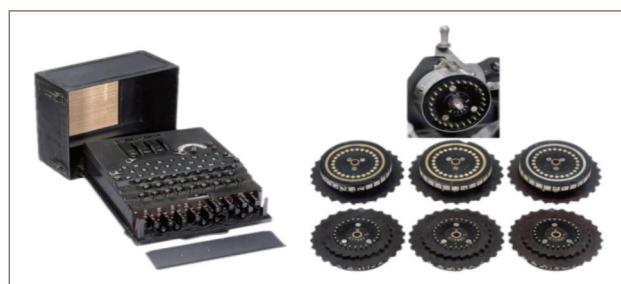
图9 英格玛密码机 (产地: 德国, 生产时间: 1944 年)
